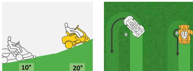
Cub Cadet Zero-Turns bewältigen mit 20° doppelt so steile Hänge wie Frontmäher. Mehr noch: Sie können sogar schräg am Hang fahren und dabei problemlos die Linie halten. Außerdem drehen Cub Cadet Zero-Turns auf der Stelle anstatt bis zu 70 cm Radius zu benötigen. Die Null-Wendekreis Technik macht's möglich.
