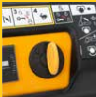
BEKVÄM EL-START Vrid på nyckeln och gräsklipparen startar.
